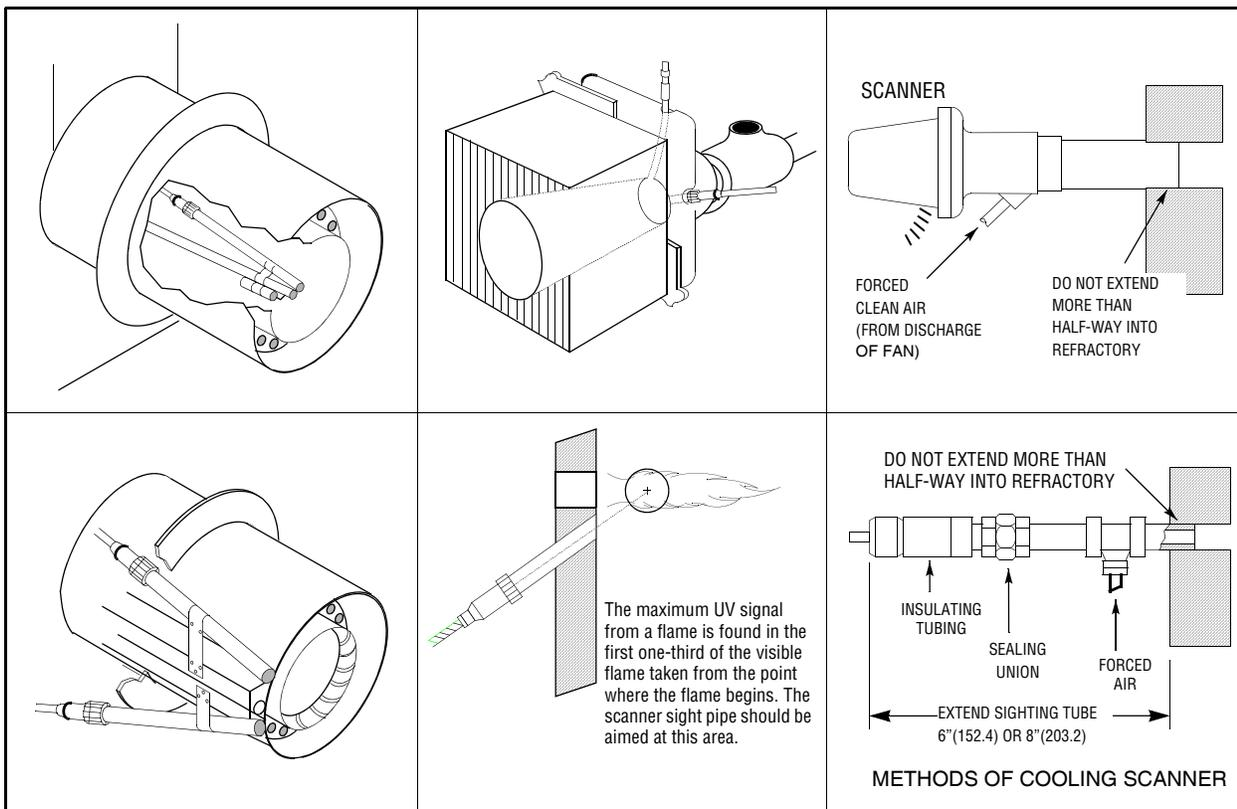
**OPERATION — 45UV5 & 55UV5 SELF-CHECKING UV SCANNER**
