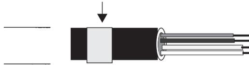
**4. FOLD BACK BRAIDED SHIELD OVER SUPPORT SLEEVE AND TRIM FOIL SHIELD.**
